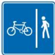
INFRAESTRUCTURA CICLISTA ADJUNTA A ÁREA PEATONAL
